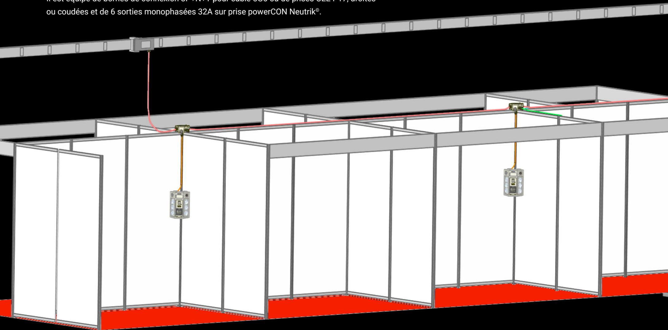
Grâce à la limitation électronique de la puissance, intégrée dans les coffrets de la gamme ACCESS, un seul câble d'infrastructure permet de raccorder efficacement plusieurs coffrets ACCESS, selon la puissance programmée.
