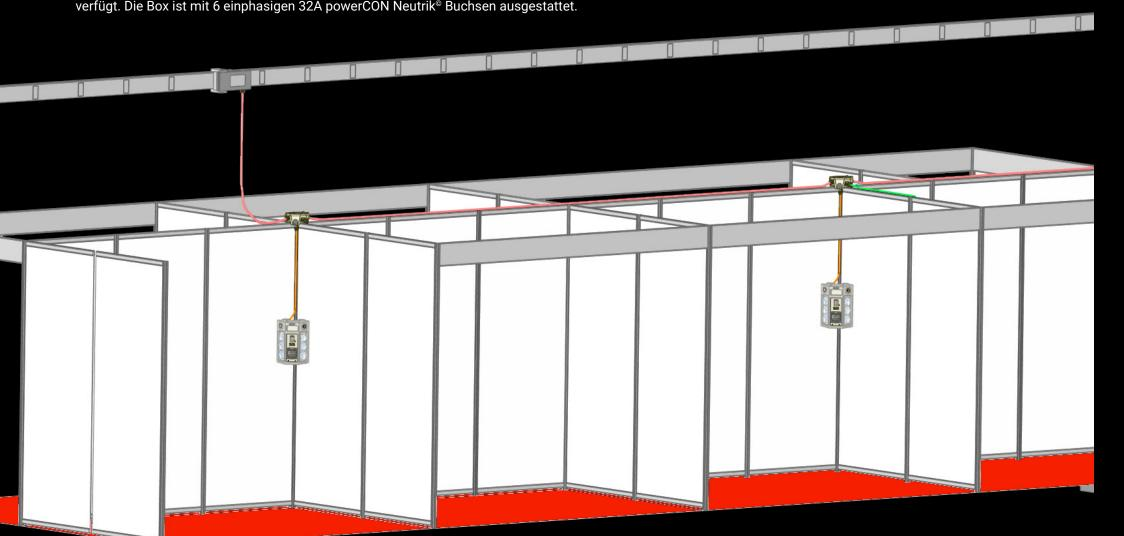
Ein SPLITTER, an das Drehstromnetz angeschlossen, kann, dank der elektronischen Leistungsbegrenzung bis zu sechs COMPACT Stromverteiler effizient mit einphasigem Strom versorgen:
